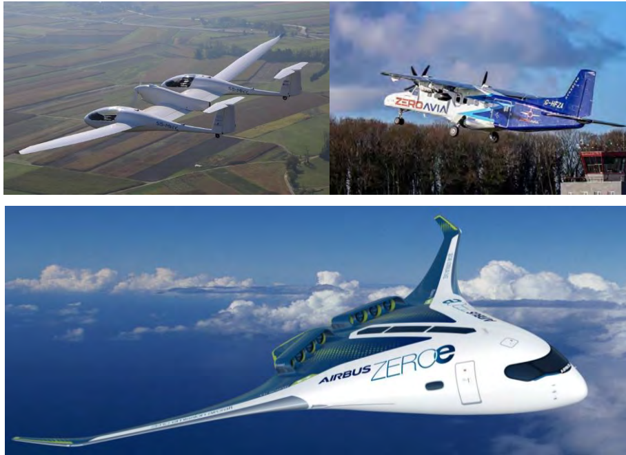
Figura 8. Diferentes prototipos de aeronaves propulsados por hidrógeno. Arriba izquierda: modelo HY4; arriba derecha: modelo Dornier 228; abajo: uno de los tres prototipos presentados por Airbus Zeroe.
